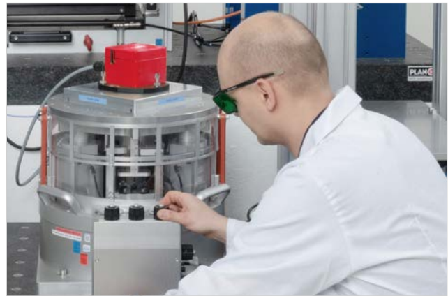
Geophon-Kalibrierung auf einem SE-13 im SPEKTRA Labor
