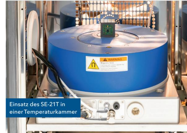
Einsatz des SE-21T in einer Temperatorkammer
